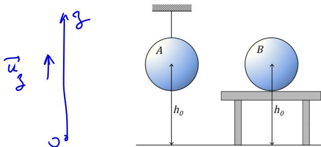
1. Lors de la dilatation le point d'attache de la sphère A est fixe alors que c'est le point de contact sur la table pour la sphère B qui est fixe. Exprimer les variations de hauteur,  $\Delta h$ , du centre de masse des sphères pour une variation de température  $\Delta T$ .
